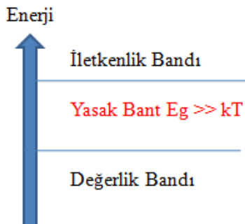
Şekil 2.11: Yalıtkan malzemeler için enerji bandının şematik gösterimi
