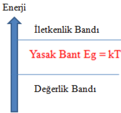
Şekil 2.12: Yarı iletkenler malzemeler için enerji bandının şematik gösterimi
