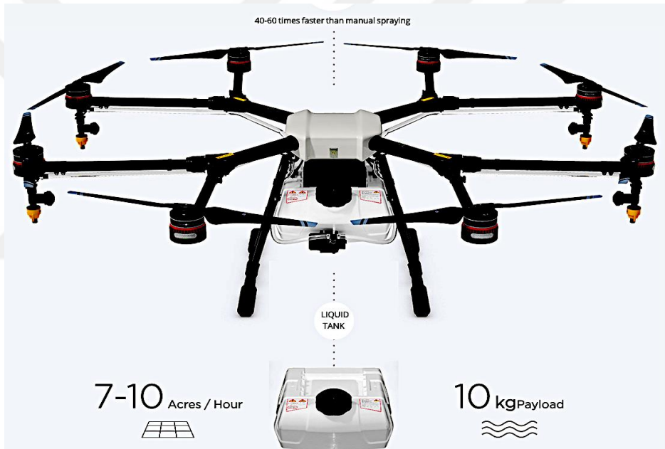
Görsel 37: DJI Agras T16 İlaçlama Drone'u. Faydalı Yük Bölümünde Kamera Yerine İlaç Tankı Bulunmaktadır.
