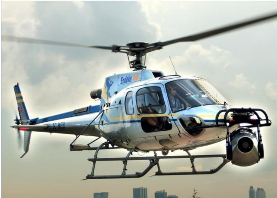
Görsel 67, 68: Organize İşler Filminde Kullanılan Elektronik Gyro Sistemi (Uğur İçbak Arşivi)
