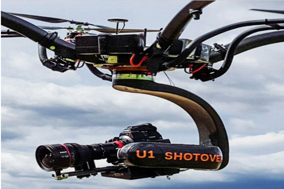
Görsel 17: Shotover U-1 Marka Drone, Üzerinde Profesyonel Sinema kamerası ve Objektifi ile.
