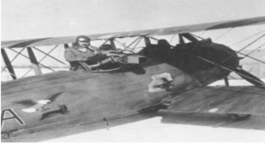
Görsel 20: Tayyareye Monte Edilmiş Şekilde Fotoğraf Çekimi Uygulaması (Güvenbaş, 2019: 71)
