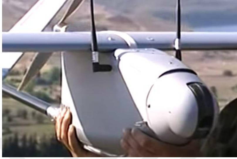
Görsel 40: Bayraktar Mini İHA’da Kullanılan Kamera ve Gimbal
