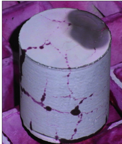
Şekil 3.2. 60 s mikrodalgaya maruz bırakma ile numunede gelişen çatlaklar (Hartlieb ve ark., 2012).
