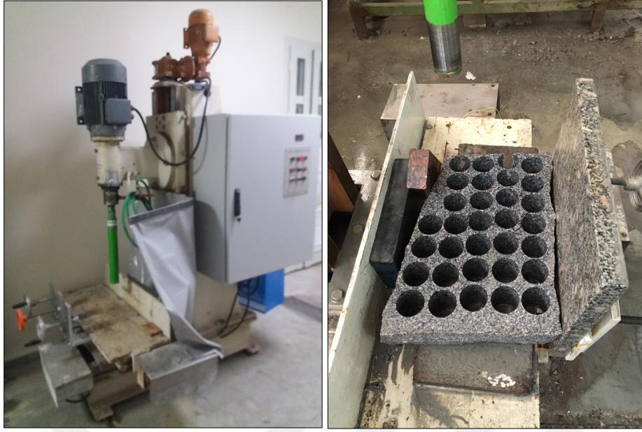
Şekil 4.1. Karot alma işlemlerinde kullanılan makine.
