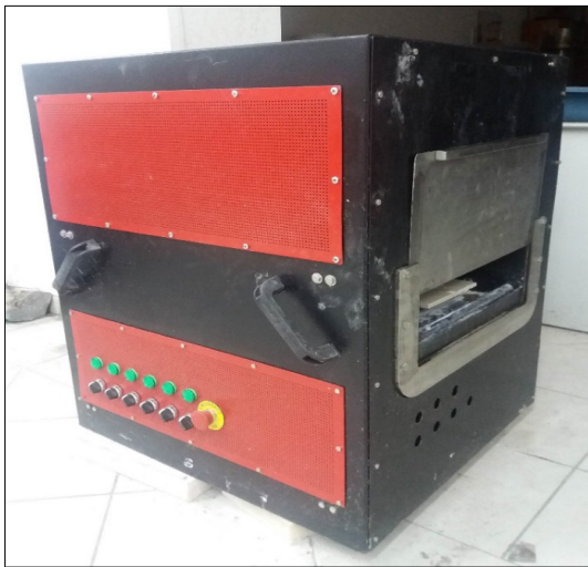
Şekil 4.10. Deneylerde kullanılan 6 kW endüstriyel tip mikrodalga fırın.
