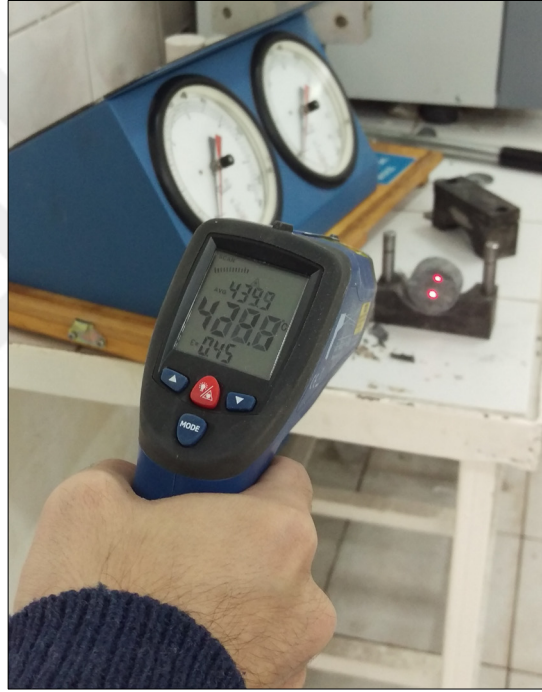
Şekil 4.11. Kızılötesi termometre ile numune sıcaklıklarının ölçülmesi.
