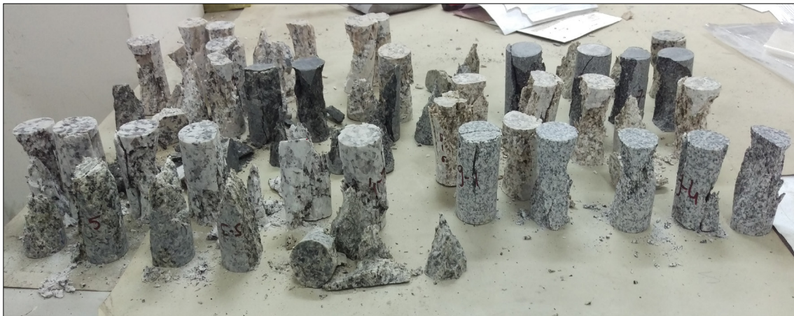
Şekil 4.9. UCS deneyi uygulanmış bazı silindirik numuneler.
