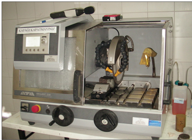
Şekil 4.2. Tam otomatik karot kesme makinesi.
