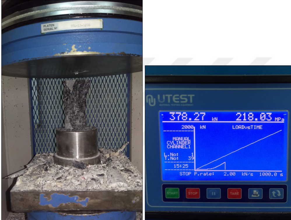
Şekil 4.8. UCS deneyinin Nero Turka gabrosuna uygulanması.
