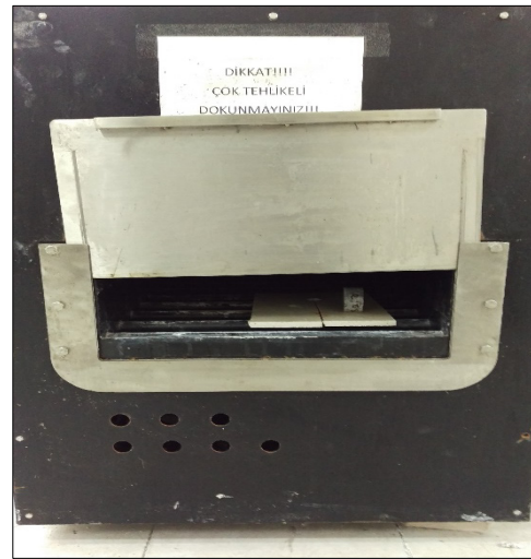
Şekil 4.10. Deneylerde kullanılan 6 kW endüstriyel tip mikrodalga fırın.
