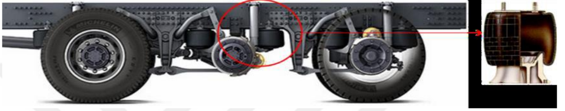
Şekil 2.4. Yük taşıtı üzerinde pnömatik bir yay (Çallı 2015)
