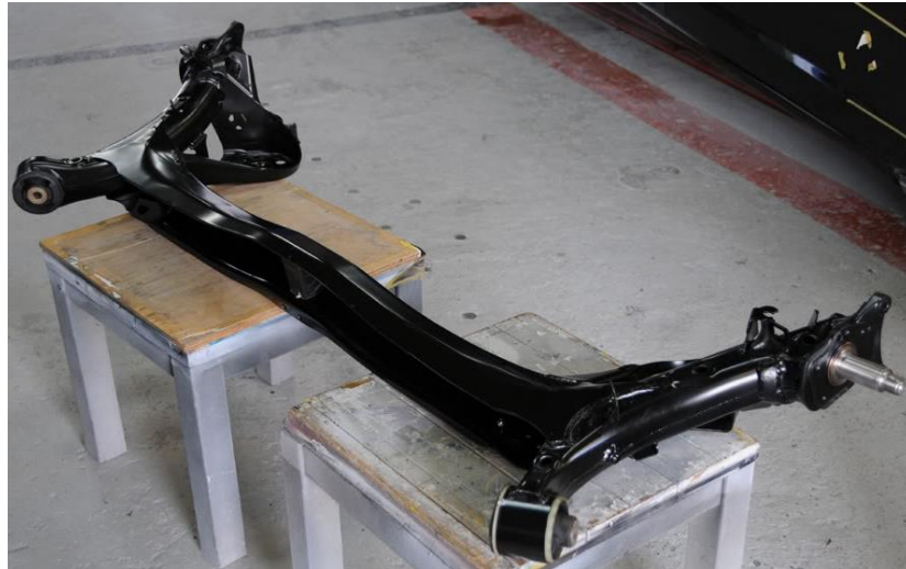
Şekil 2.17. Örnek bir burulma kirişi kesiti (Anonim 2019k)
