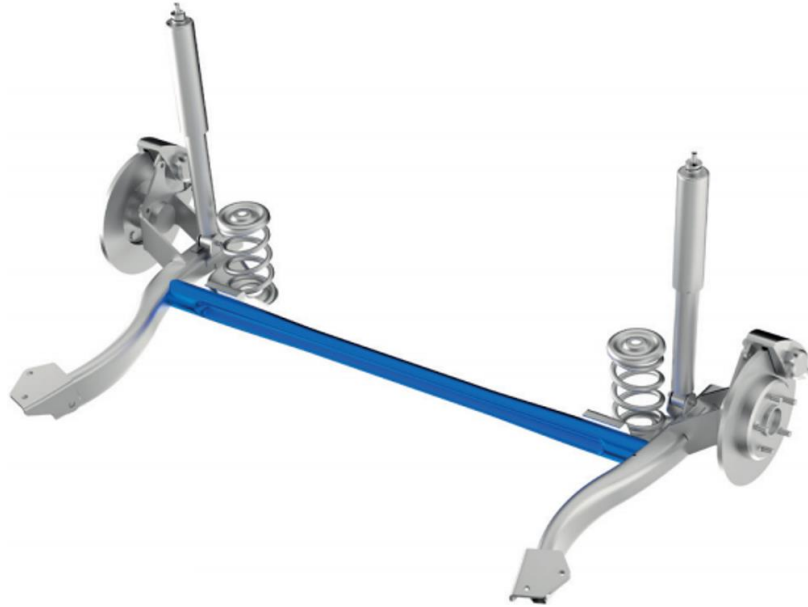
Şekil 2.19. Örnek formlanmış boru kesitli bir burulma kirişi (Anonim 2019l)
