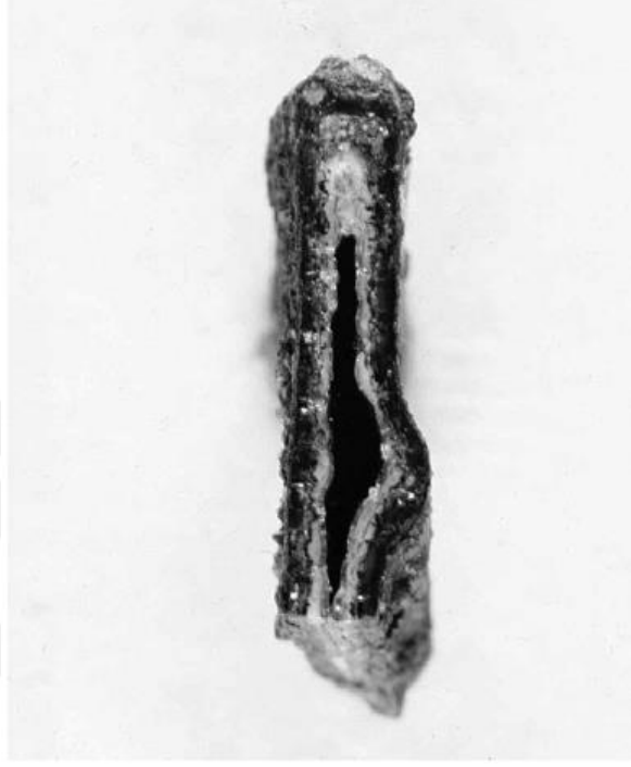
Şekil 3.9: İleri derecede süt beyazı- mine aşınma görülen bir camın kesitinden görüntü (Davison, 2006: 185)
