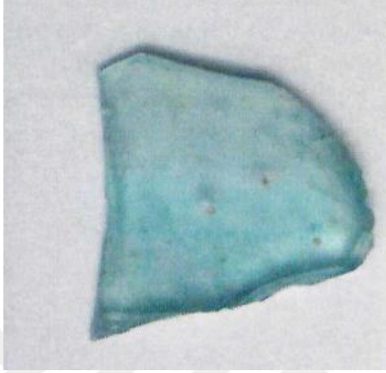
Şekil 3.5: Camda matlaşma örneği (Caner-Saltık, 2012: 59)
