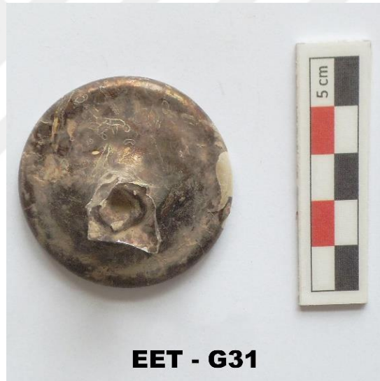
Şekil 3.8: Camda süt beyazı/mine aşınma oluşumu
