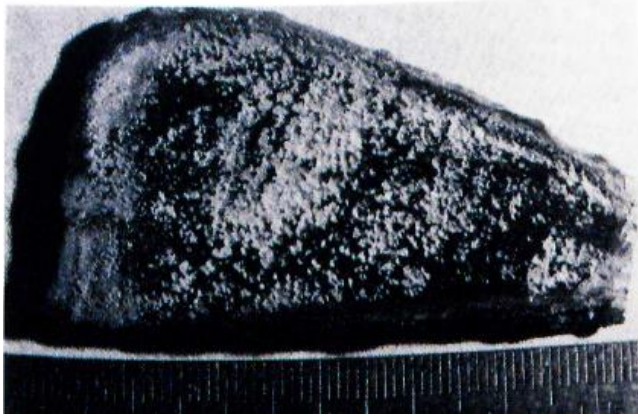
Şekil 3.12: Çok küçük (0.1-0.2 mm) çukur oluşumu
