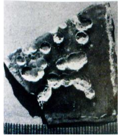
Şekil 3.13: Beyaz birikimli büyük (<5 mm) çukur oluşumu
