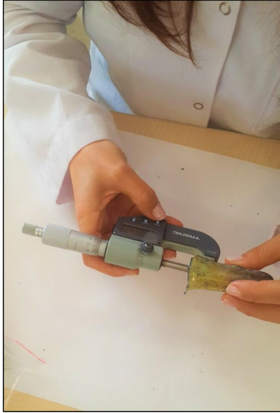
Şekil 4.3: Enez cam örneklerinin kalınlık ölçümü
