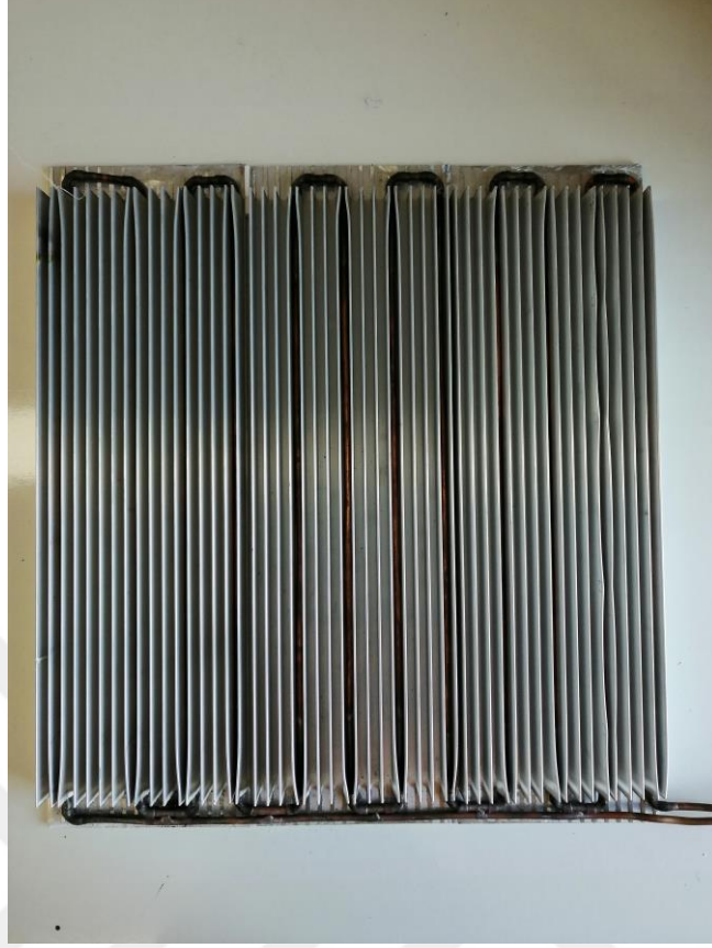
Şekil 4.7 Bakır boru döşenmiş soğutucu
