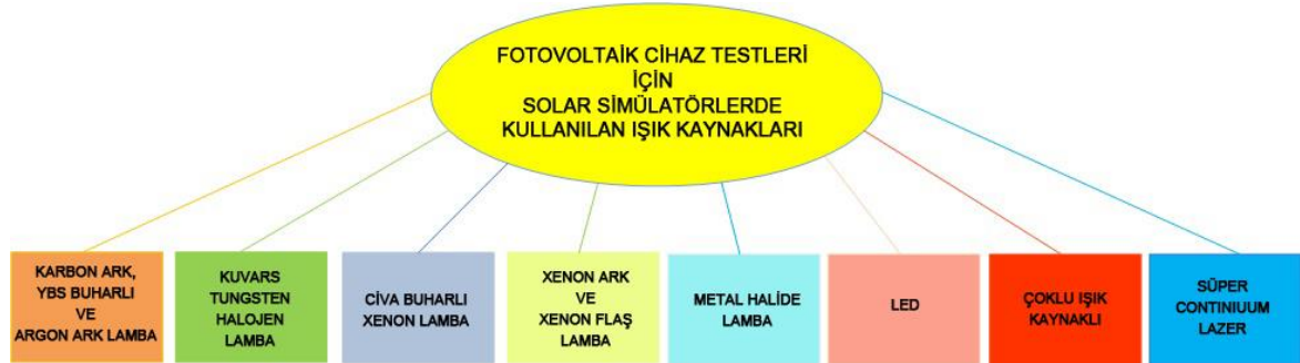
Şekil 2.25 Solar simülatörlerde kullanılan ışık kaynakları
