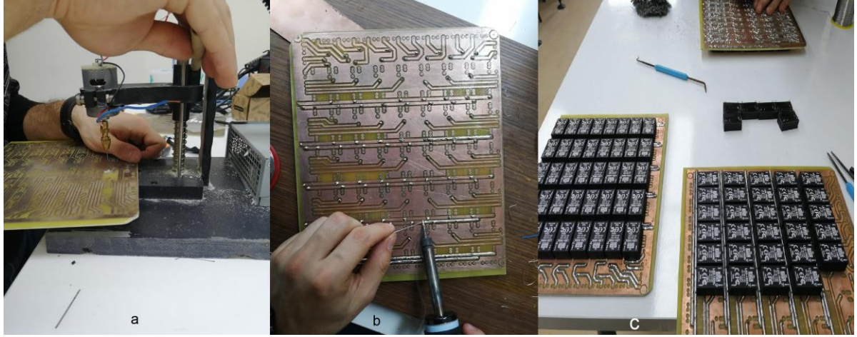
Şekil 4.14 (a) Sürücü kartlarının delinmesi, (b) Sürücü kartlarının lehimlenmesi, (c) Sürücülerin karta montajı
