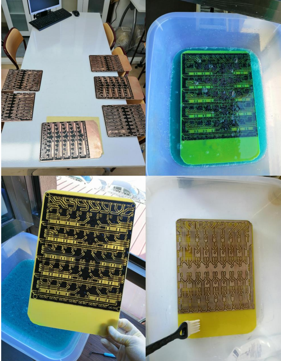
Şekil 4.13 Sürücü kartlarının kimyasal işlemleri
