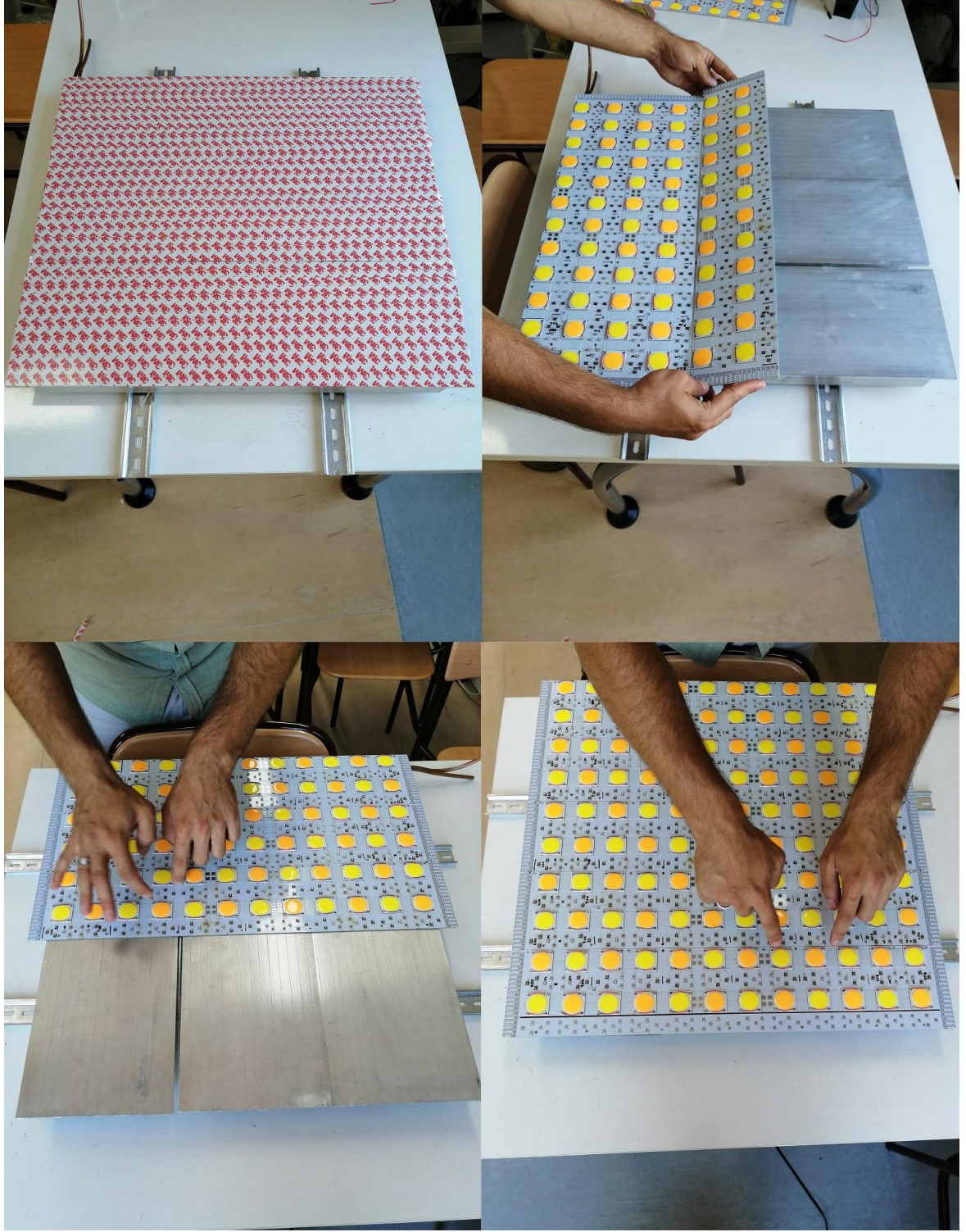
Şekil 4.8 PCB'lerin soğutucu üzerine montajı
