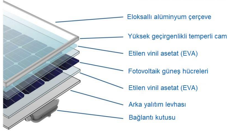
Şekil 2.14 Fotovoltaik panelin fiziksel yapısı[56]
