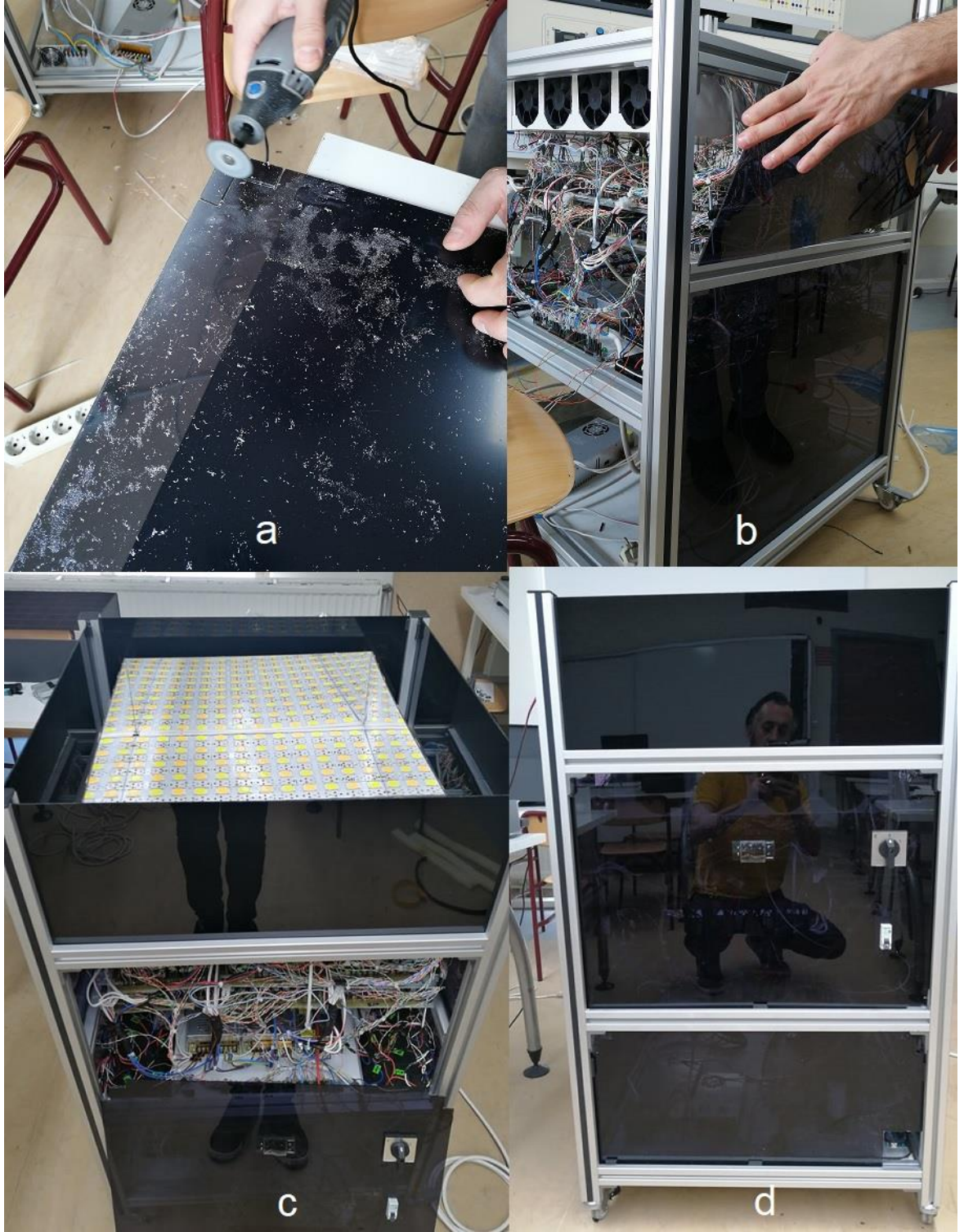
Şekil 4.26 (a) Pleksilerin kesilmesi, (b) Pleksilerin alüminyum profillere takılması, (c) Ön kapağın hazırlanması, (d) Solar simülatör gövdesinin tamamen kapatılmış hali
