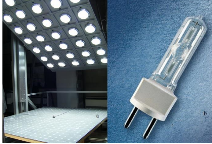
Şekil 2.30 (a) Metal halide ışık kaynaklı solar simülatör örneği, (b) Metal halide lamba [127]
