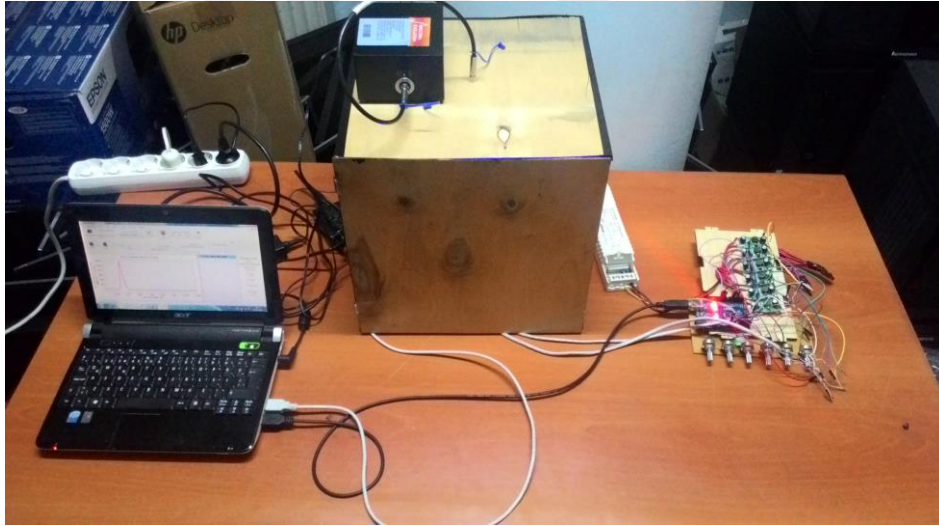
Şekil 3.18 Dalga boyu ölçümü test düzeneği
