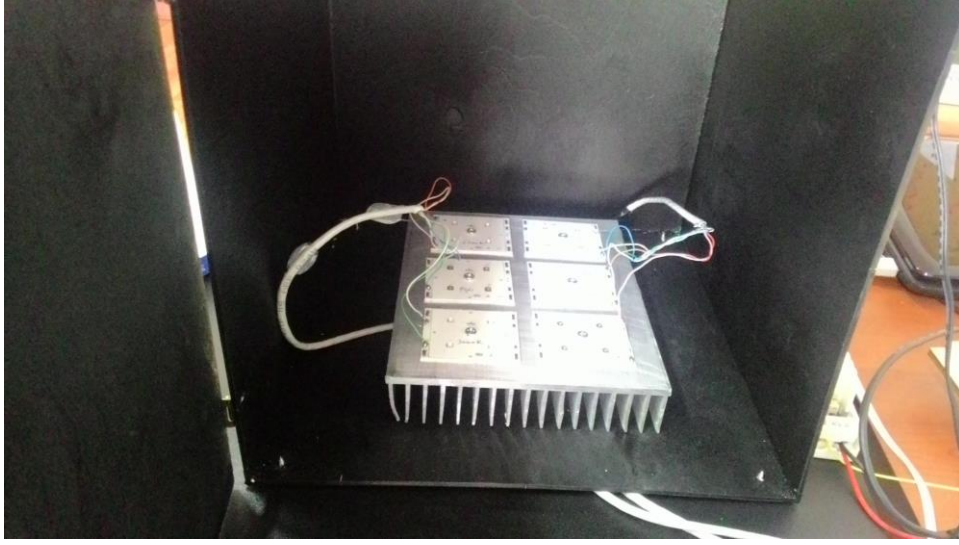
Şekil 3.17 LED'lerin karakutu içine yerleşimi
