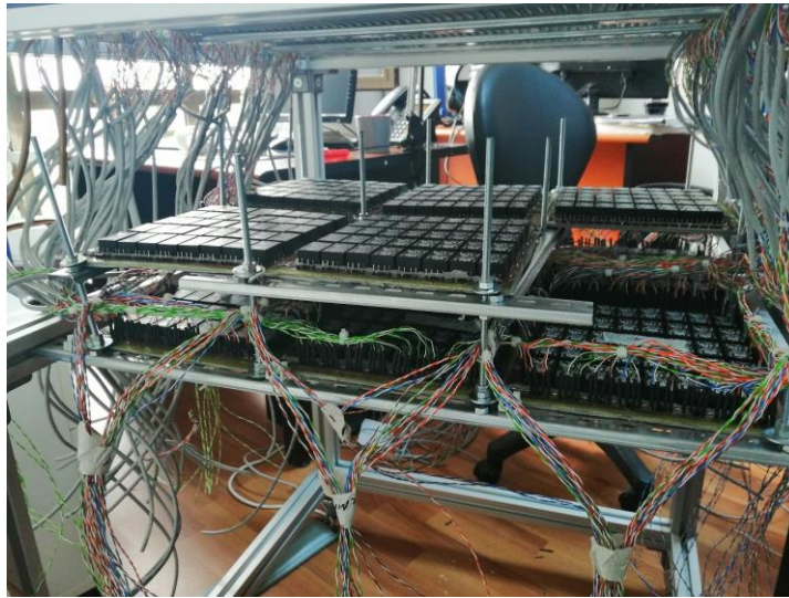
Şekil 4.20 İkinci sürücü katının yerleştirilmesi
