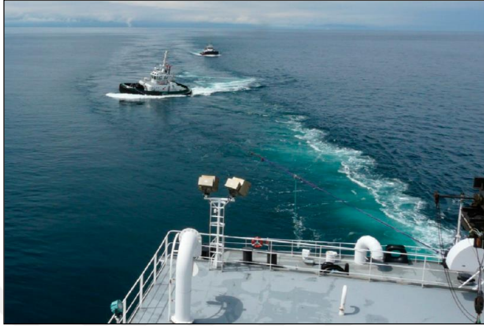
Şekil 21: Dolaylı Çekme Yöntemi ile Verilen Bir Eskort Hizmeti
