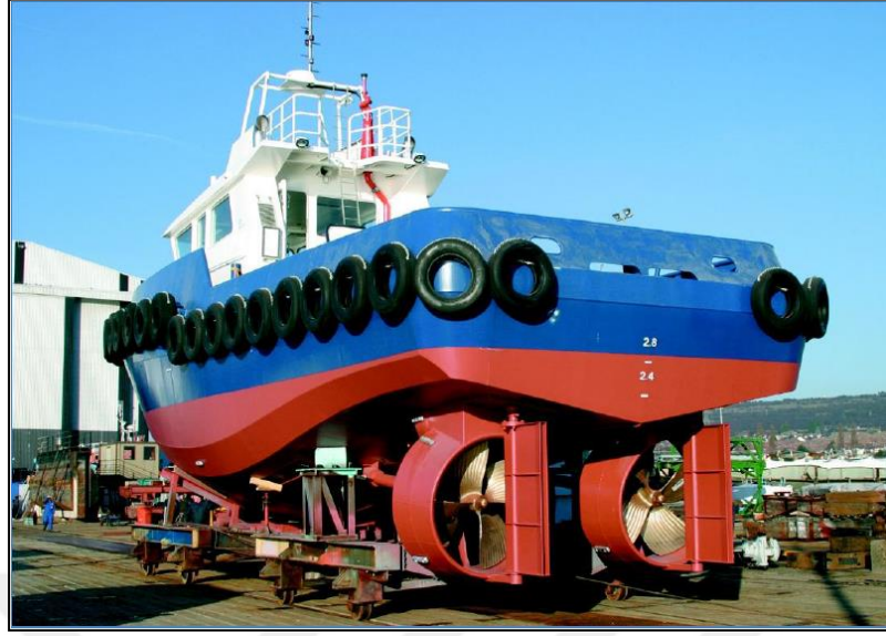
Şekil 11: Çift Pervaneli ve Sabit Nozullu Bir Konvansiyonel Römorkör
