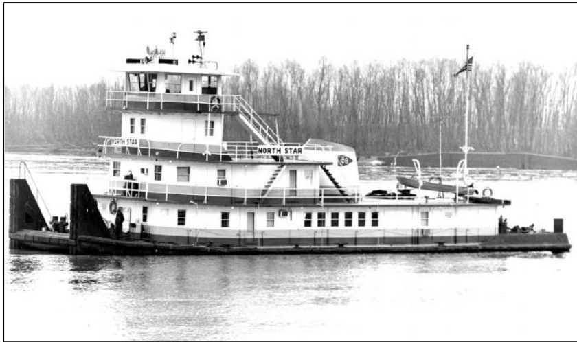
Şekil 10: Uzak Mesafe Nehir Taşımacılığında Kullanılan Bir Römorkör (Line Haul Towboat)
