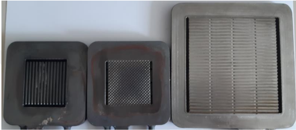
Fotoğraf 1.2. Farklı kanal tasarımlarına ve boyutlarına sahip interkonnektörler
