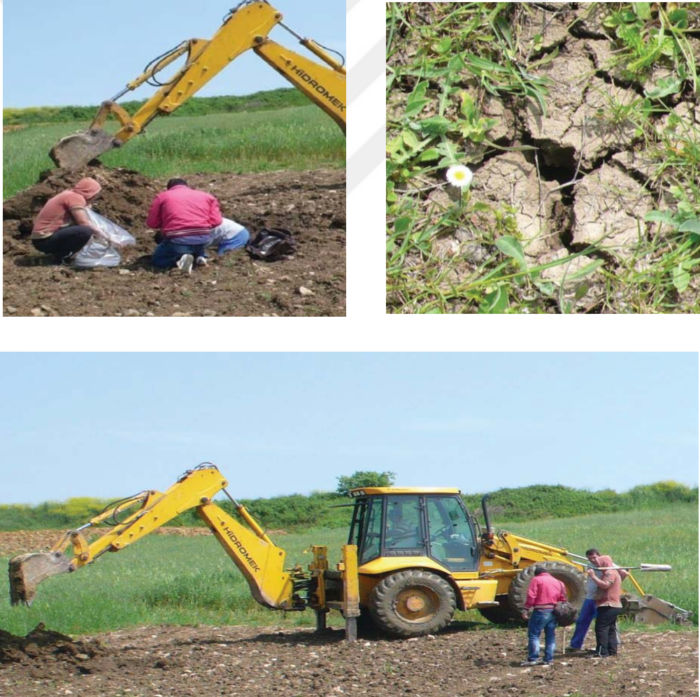
Şekil 3.12. Toprak profillerin de bazı morfolojik çalışmalar ve bozulmuş toprak örnek alımları
