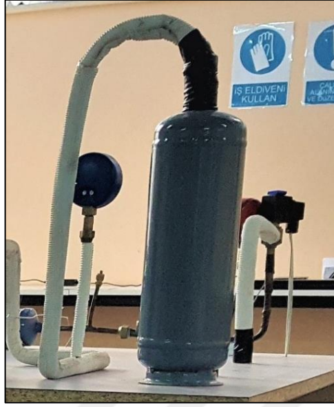
Şekil 4.12. Düşük sıcaklık devresi sıvı tutucusu (akümülatör).
