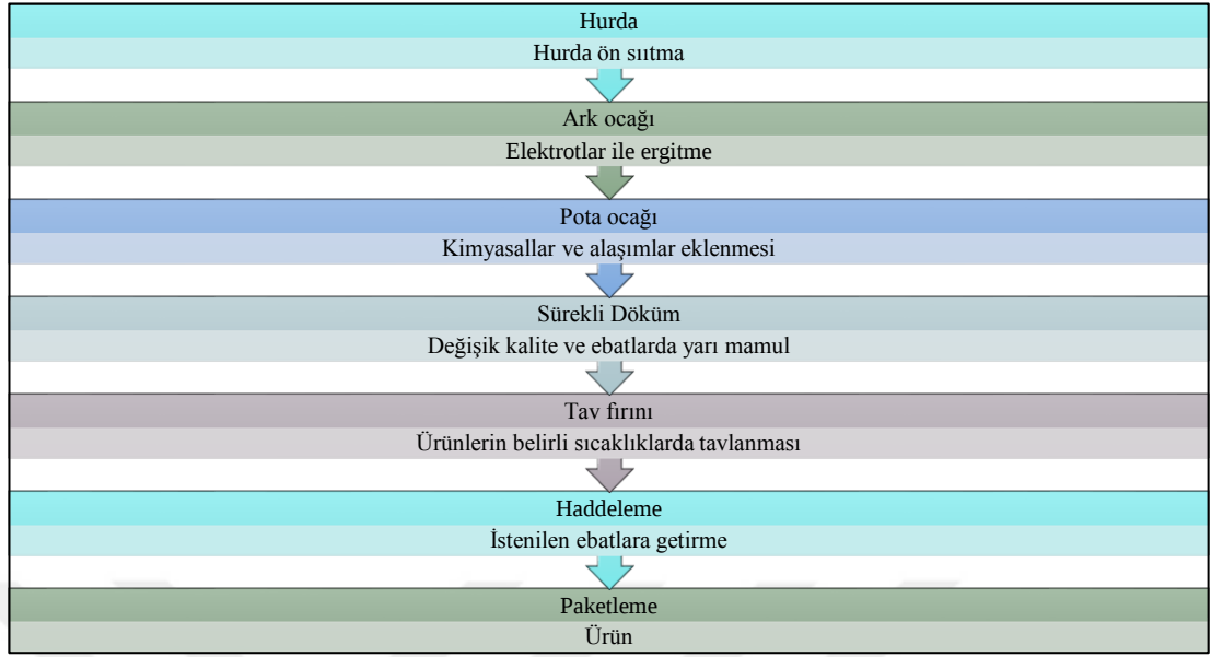
Şekil 4.2. Ark ocaklı demir çelik sektörü proses akış şeması
