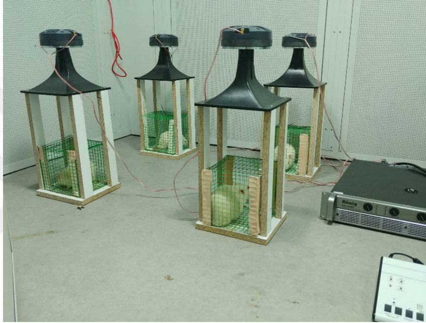
Şekil 3.3. Ratlara gürültü verilme düzeneği.
