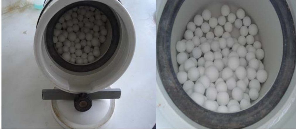
Şekil 3.4. Alümina bilyeli değirmenin değişik açılardan görünümü
