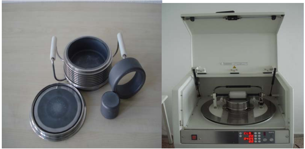
Şekil 3.3. Tungsten karbit değirmenin değişik açılardan görünümü
