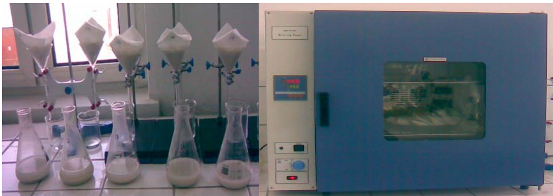
Şekil 3.9. Numunelerin liçi işlemi sonrası filtrasyonu ve kurutulması
