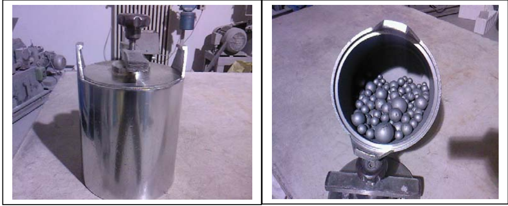
Şekil 3.1. Bilyalı değirmenin değişik açılardan görünümü
