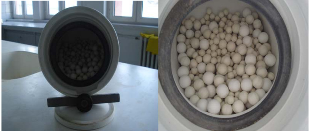
Şekil 3.2. Seramik(Q) bilyeli değirmenin değişik açılardan görünümü
