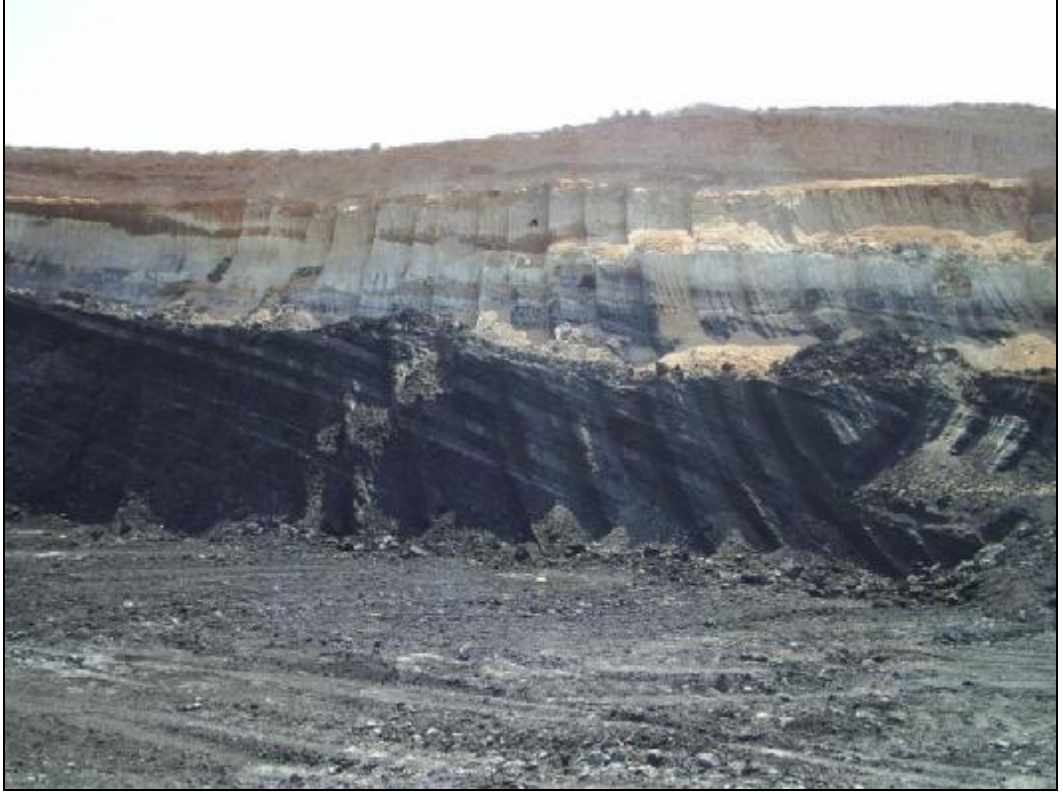
Şekil 3.11. Linyit horizonundan bir görünüm; eğimli tabakalar
