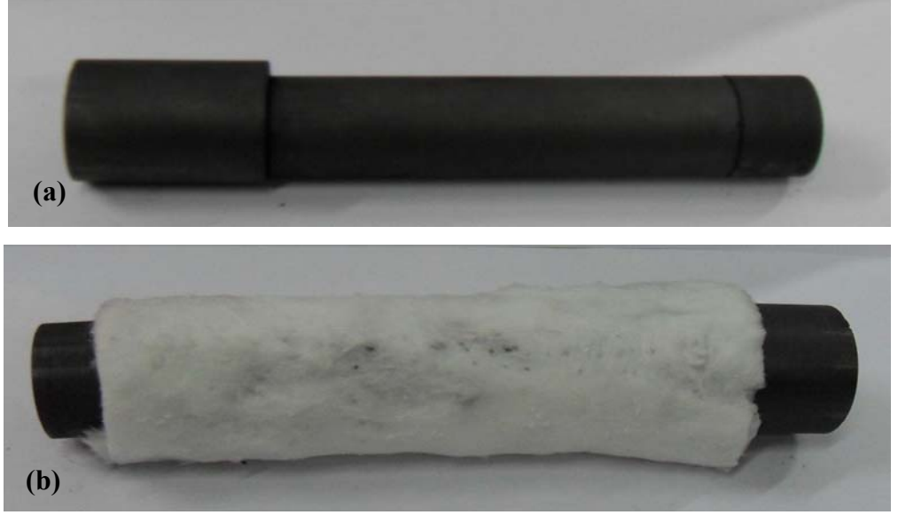
Şekil 3.17.(a) Döküm fırınına yerleştirilmek üzere hazırlanan ve (b) etrafına cam pamuğu sarılan numune kalıbının fotoğrafı.
