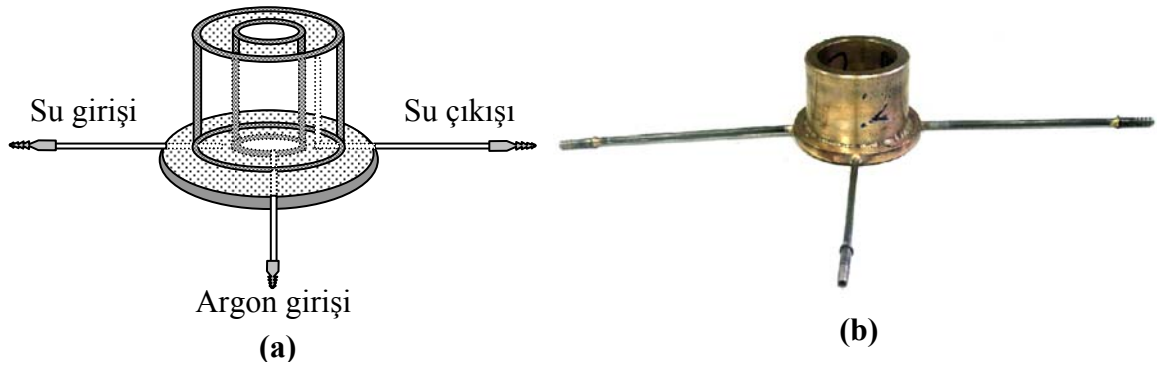
Şekil 3.6. Pirinçten yapılan soğutma kapağının (a) Şematik gösterimi, (b) Fotoğrafı.
