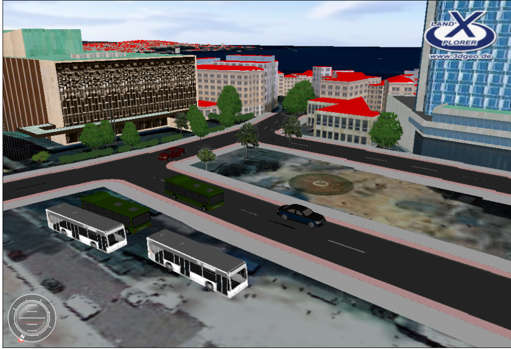
Şekil 6.50 LoD3 ayrıntı düzeyinde 3B Kent modeli
