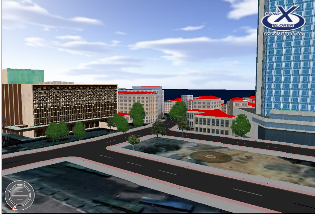
Şekil 6.49 LoD3 ayrıntı düzeyinde 3B Kent modeli
