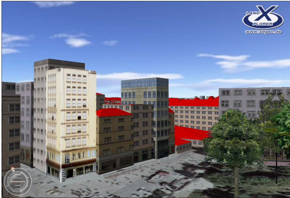
Şekil 6.39 LoD2 ayrıntı düzeyinde 3B kent modeli
