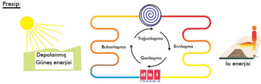
Şekil 3.1. Toprak kaynaklı ısı pompası sistemine örnek
