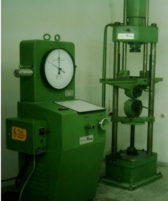
Resim 3.2. 2–20 Ton arası presleme basıncındaki pres
