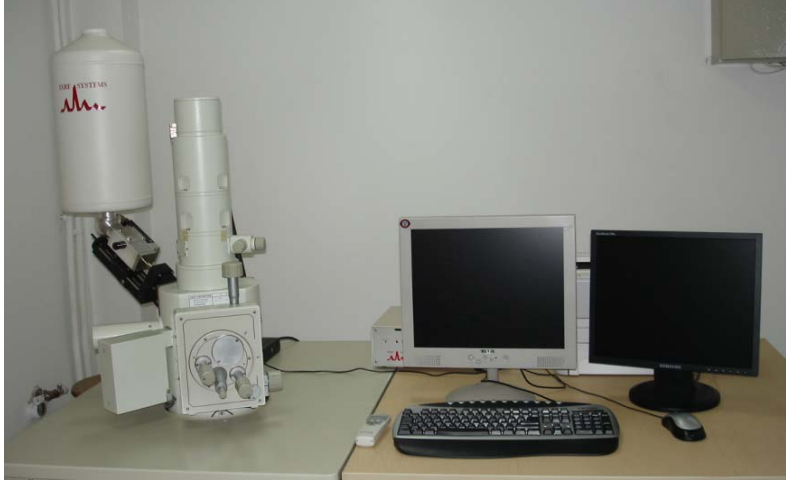
Resim 3.4. JOEL JSM-5600 model taramalı elektron mikroskobu ve EDS bağlantısı
