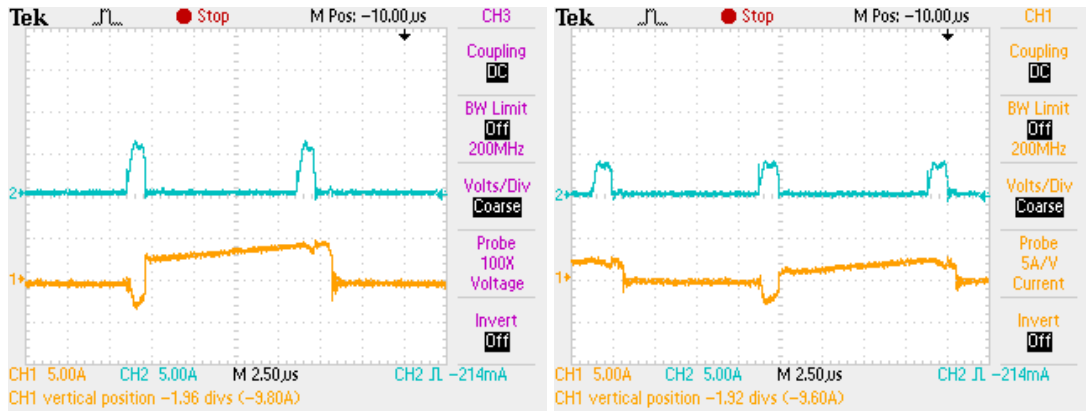
Şekil 7.20. Farklı giriş akımı değerlerinde; M_1 ana anahtarın ve M_a yardımcı anahtarın akım dalga şekilleri ( i_{D1} , i_{DMa} )
