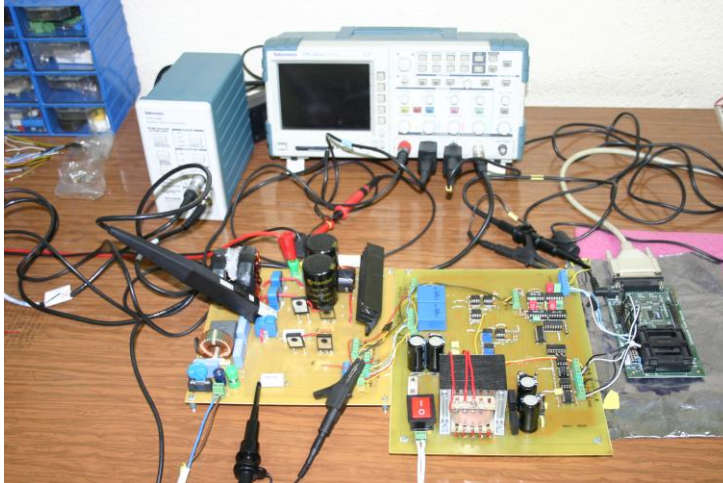
Resim 7.1. Ortalama akım kontrollü önerilen SGG sarmaşık yükselten GKD devresinin prototipi
