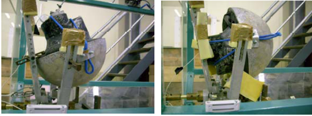
Resim 5.8. Metal köpük kaskların ön ve üst darbelere karşı test edilmesi [43]
