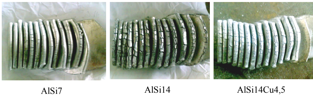
Resim 7.1. 30x50 mm’lik kalıpta preslenmiş, 3 saat sinterlenmiş ve sonrasında %50 sıcak deforme edilmiş köpürmeye hazır ön malzemeler
