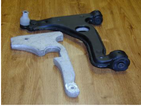
Resim 5.2. İçerisine Al köpük konularak desteklenmiş süspansiyon parçası [32]
