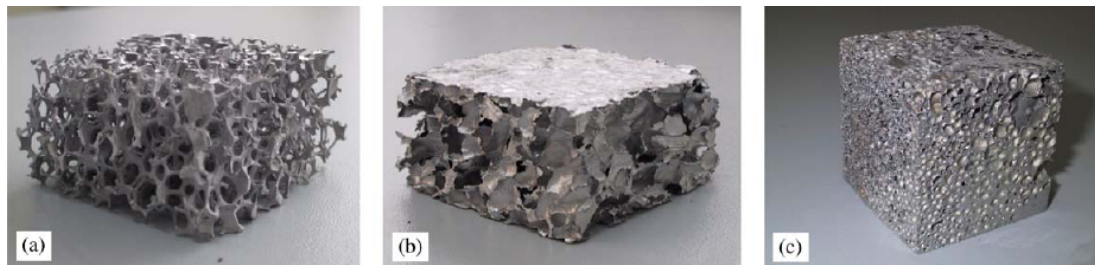
Resim 2.2. Köpük örnekleri: (a) açık hücreli M-PORE tarafından hassas döküm ile üretilmiş, (b) kapalı hücreli CYMAT tarafından ergiyiğe gaz ilavesi ile üretilmiş, (c) kapalı hücreli SCHUNK tarafından toz metalurjisi yöntemi ile üretilmiş [14]
