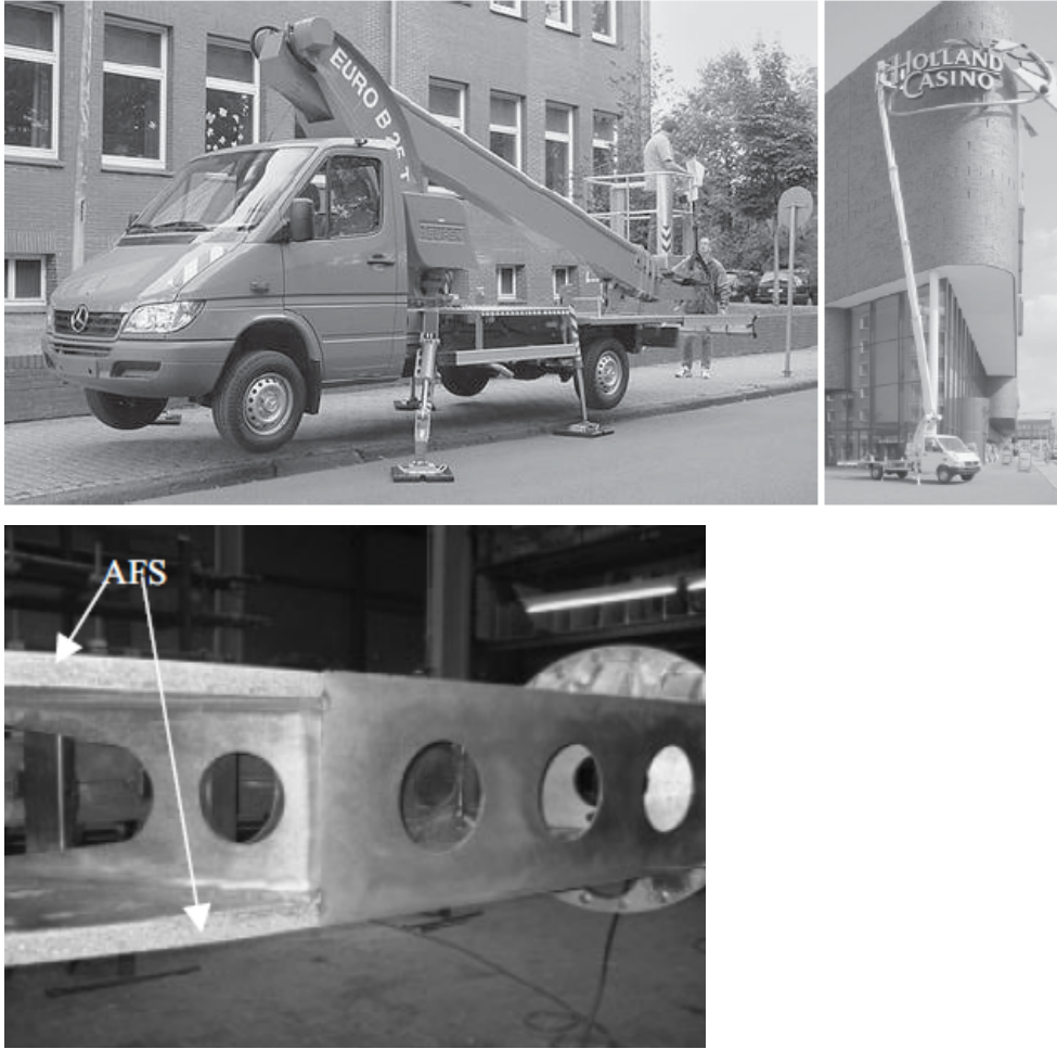
Resim 5.9. Alüminyum sandviç köpük kullanılmış Teupen EURO B25T kaldırıcı kol destekli araç [20,44]
