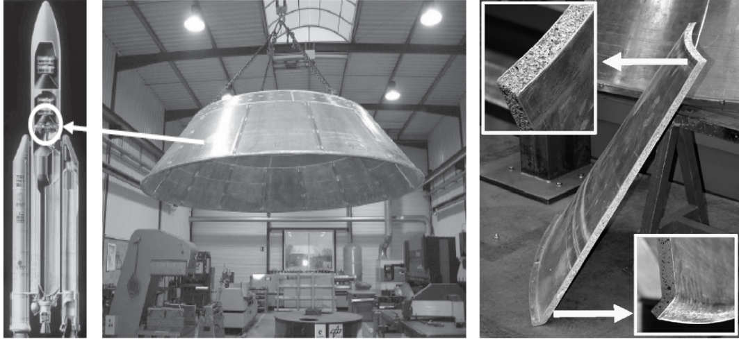
Resim 5.10. Arine 65 roketinin AFS den yapılan koni prototipi a) parçanın roketteki konumu b) koninin birleştirilmiş hali [20] c) AFS' nin detay görüntüleri [45]
