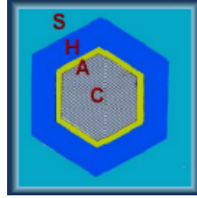
Şekil 1- Hidroksiapatit kristalinin komponentleri C: Kristal çekirdek, A: İyonik adsorbsiyon tabakası, H: Hidratasyon tabakası, S: sulu organik materyal (106)
