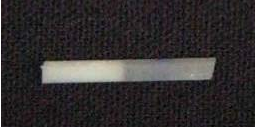
Resim 6. Mikrogerilme bağlanma dayanımı testi için hazırlanmış örnekler
