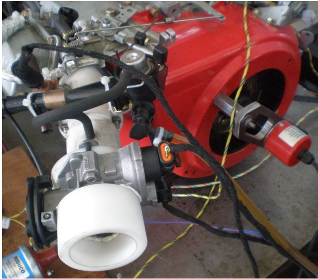
Resim 4.1. Deney motoru için yapılan emme manifoldunun motora bağlantısı
