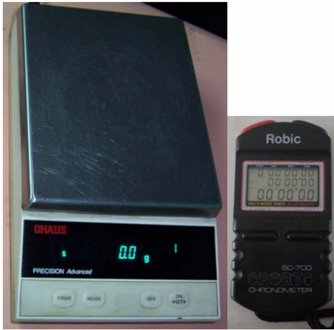
Resim 3.6. Hassas terazi ve kronometre
