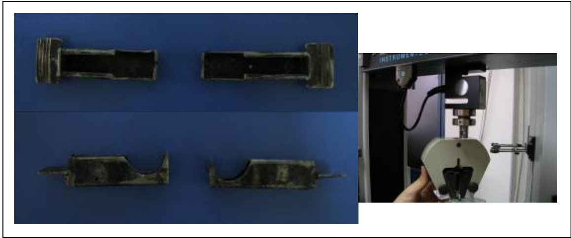
Şekil 3.4. İlk denenen klemp sistemi ve tensil test cihazı üzerine sabitlemek için kullanılan çeneler
