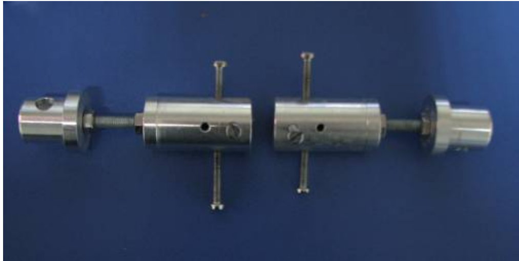
Şekil 3.5. İkinci olarak denenen sistemde kemik diafiz ve metafizleri alüminyum tüpler içinde vida ile sabitleniyor
