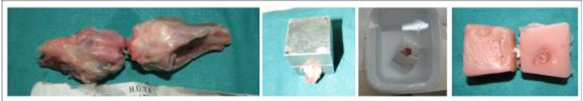
Şekil 3.9. Diseke edilmiş femur-ÖÇB-tibia kompleksi, B ve C. Örnekler alüminyum kalıp içinde PMMA'ya gömme sırasında %0.9'luk SF ile ıslatıldı, D. Kemikler tamamen PMMA içine gömülmüş halde, sadece test edilecek bağ dışarıda bırakıldı.
