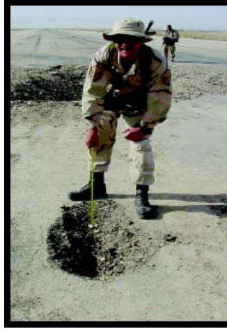
Şekil 2.6. Çukur derinliğinin ölçülmesinde çukurun en derin noktası ve sağlam zemin (U.S. Department of The Air Force, 2008 a).
