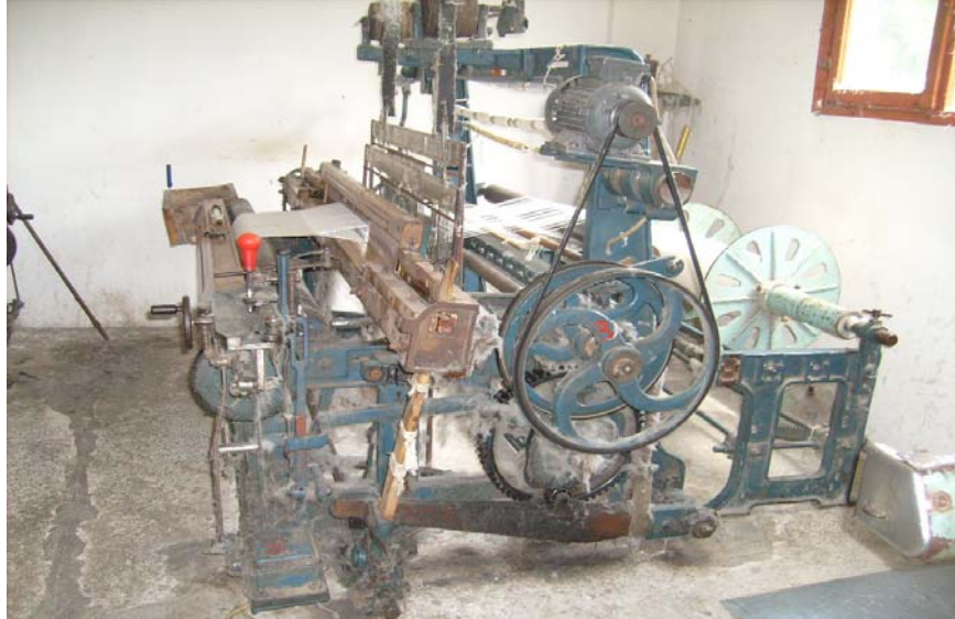
Resim 17. Mehmet Akgün'ün atölyesindeki dar enli dokuma yapan yarı otomatik tezgah.
