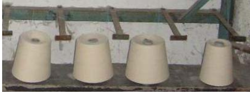
Resim 4. Denizli'den hazır halde gelen bobine sarılmıř çok bükümlü pamuk ipliđi.
