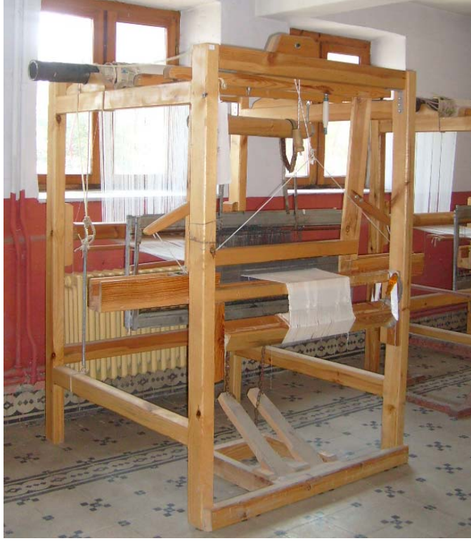
Resim 12. Şile, Merkez’deki Şile Tekstil Meslek Lisesi’nde kullanılan dokuma tezgahı.
