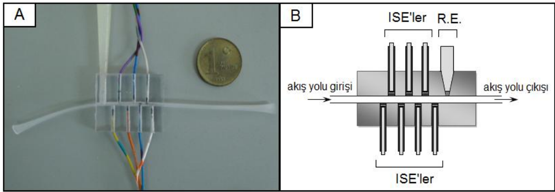
Şekil 3.3. Çalışmada kullanılan hareketli ortam ölçümlerinin alındığı sensör dizisi hücrelerinden biri (A) Hücresinin resmi (B) Hücresinin şematik gösterimi
