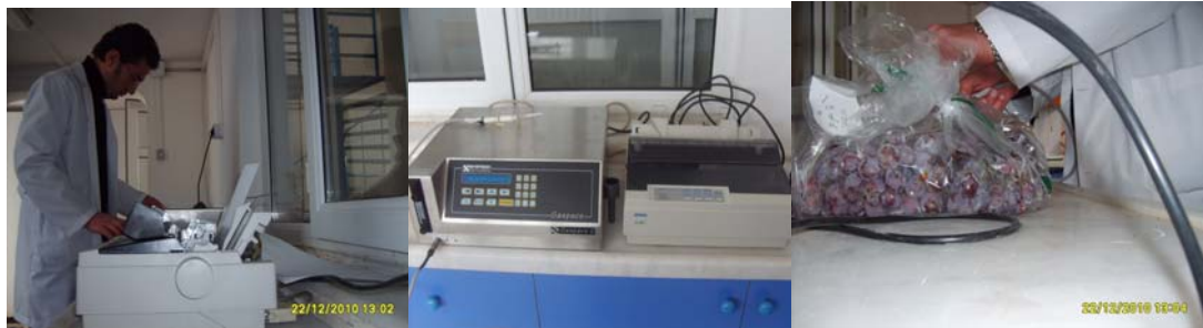
Şekil 3.15. a) Gas Spacer cihazının kalibrasyonu, b) kullanılan Gas Space cihazı c) cihaz iğnesinin poşete batırılarak poşet içi gaz bileşenlerinin ölçülmesi
