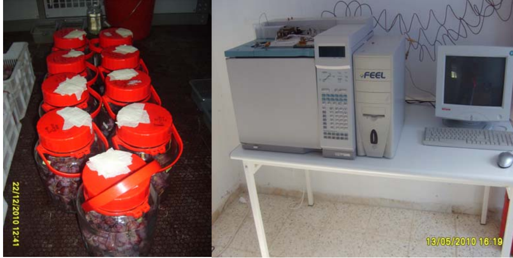
Şekil 3.14. a) Solunum hızı ölçülmesi için üzümün kavanozlara yerleştirilmesi b) Solunum hızı ve etilen değerin ölçülmesinde kullanılan GC cihazı
