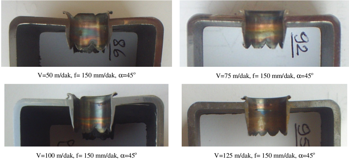
Şekil 4.24 Delme hızının petal geometrisi üzerindeki etkisi(d=10 mm)
