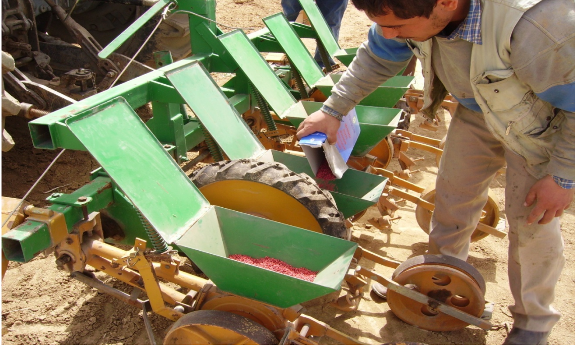
Şekil 3.4. Genetik Monogerm Şeker Pancarı Tohumlarının Mibzer Tohum Gözüne Konulması
