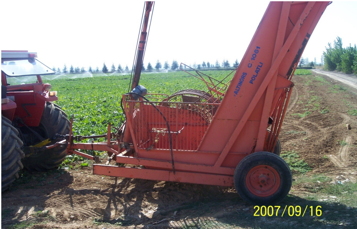
Şekil 3.2. Araştırmada Kullanılan Şeker Pancarı Hasat Makinası
