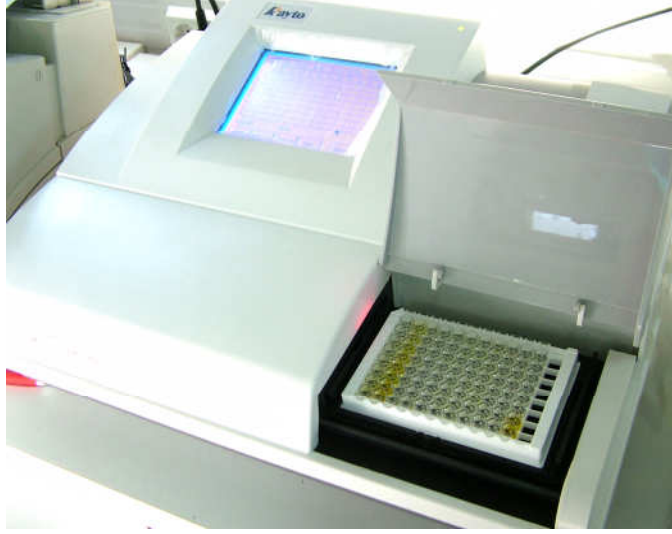
Resim 5.5. Deney prosedürü tamamlanmış plate 'in ELISA okuyucuya yerleştirilmesi ve abzorbanın ölçülmesi.
