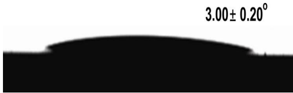
Şekil 7.4. Islak aşındırma ve UV/O 3 tekniği ile hidroksilenmiş hidrofilik yüzeyin su değme açısı görüntüsü
