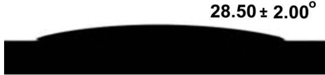
Şekil 7.18 PNIPAM fırçaların su değme açısı görüntüsü
