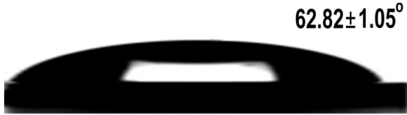
Şekil 7.3. Hidroksillenmeden önceki silisyum yüzeyin su değme açısı görüntüsü
