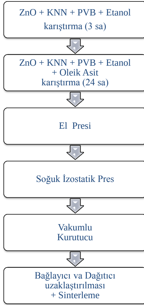
Şekil 3.2 Molce % 2 ZnO katkılı KNN üretim prosedürü
