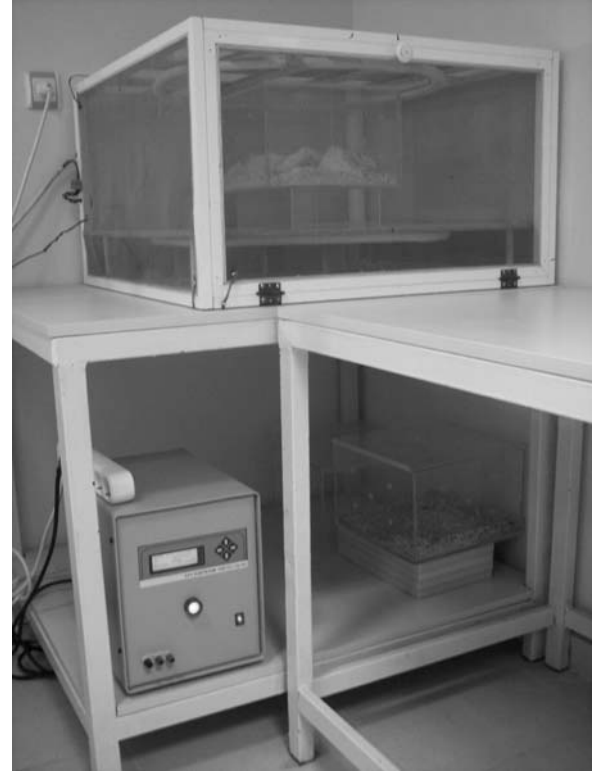
Şekil 3.8 Pulslu manyetik alan uygulama kabini ve sistemi
