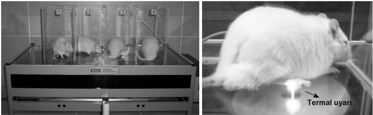
Şekil 3.11 Termal plantar test sistemi. Gövde, sıçanların konduğu cam tabaka ve bunun altında bir kolla istenen konuma hareket ettirilebilen termal radyan kaynağından oluşur. Zaman ölçme sistemi radyant enerjinin uygulanmaya başlaması ve sıçanın pençesini çekmesi arasındaki süreyi ölçer. Isıtıcı sıçanların bulunduğu cam plakanın ayarlanan sıcaklıkta kalmasını sağlar.
