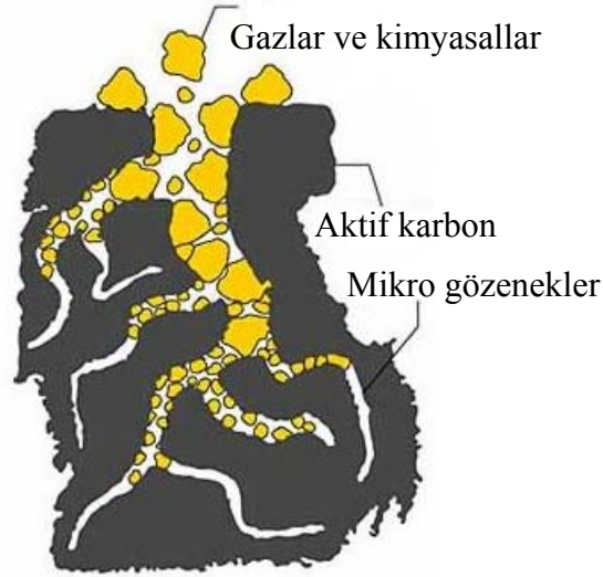
Şekil 1.7. Aktif karbonunun mikro gözenekli yapısal görünümü
