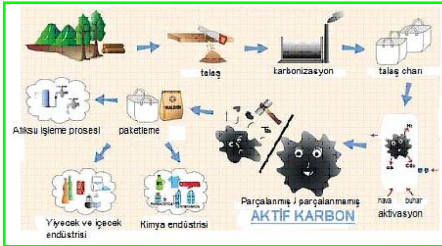
Şekil 1.13. Lignoselülozik materyallerden aktif karbon üretimi işlem basamakları
