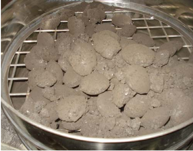
Resim 4.2. Düşme sağlamlığı deneyi sonrası elek analizi
