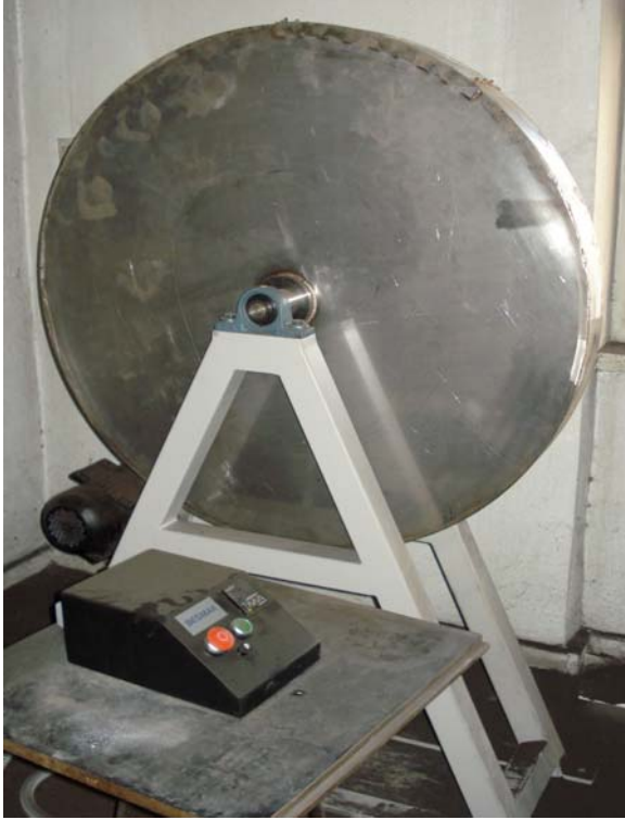
Resim 4.3. Aşınma sağlamlığı deneyi için kullanılan tambur
