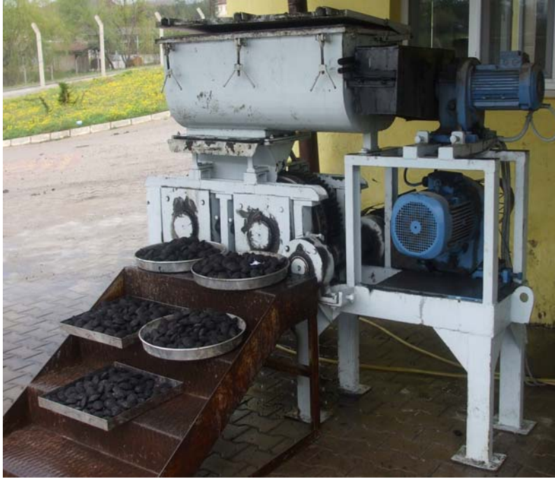
Resim 4.1. Briket makinesi ve elde edilen briketler
