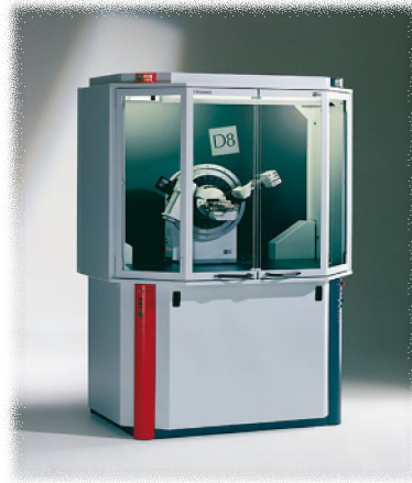
Şekil 3. 3. X-İşınları Toz Difraksiyon Ölçümleri (XRD) İçin Kullanılan Bruker AXS D8 Advance Tipi Difraktometre
