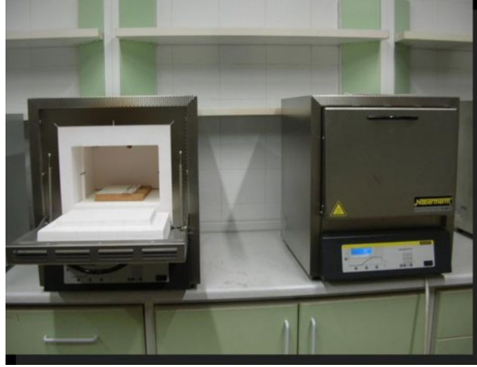
Şekil 3. 2. Ön Isıl İşlemlerin Yapıldığı ve Katı Hal Reaksiyonlarının Gerçekleştirildiği Nabertherm Marka L 9 /12 B 170 ve L 9 /11 B 170 Model Kül Fırımlar
