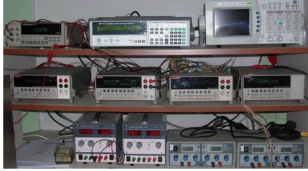
Şekil 3. 12. Ölçümlerde Kullanılan Keithley Marka Güç Kaynakları ve Elektrometreler
