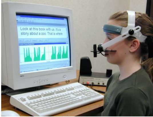
Şekil-1: Başlığın Takılması ve Mikrofonların Pozisyonu ( http-1 )
