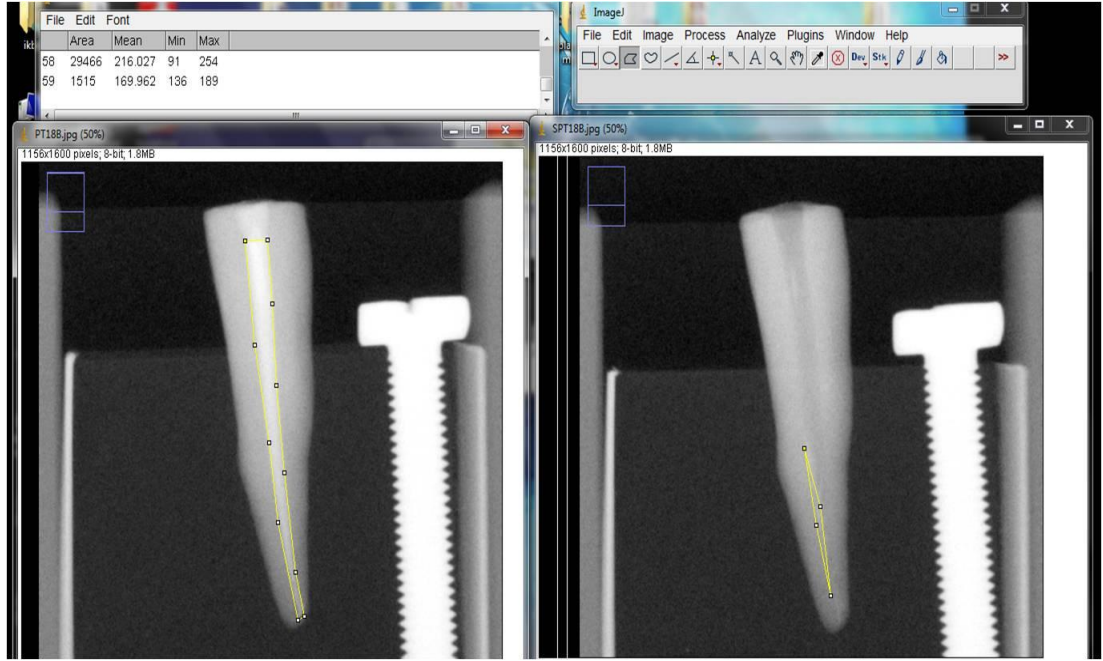
Resim 3.16: PL28 numaralı diřin bukkolingual ynde alınan radyografin zerinde kanal dolgu sınırlarının ve artık dolgu maddesi sınırlarının Image J programı ile izimi.
