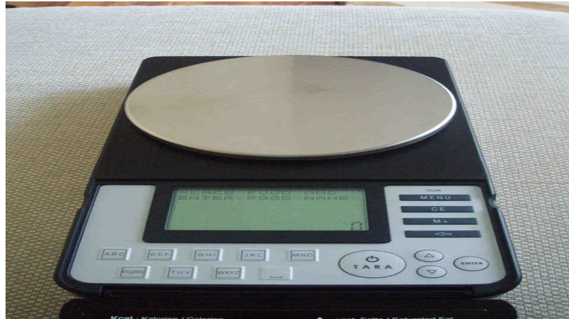
Şekil 3.1: Araştırmada ped testi ölçümünde kullanılan hassas terazi (Hassasiyet derecesi \pm 0.1 ).
