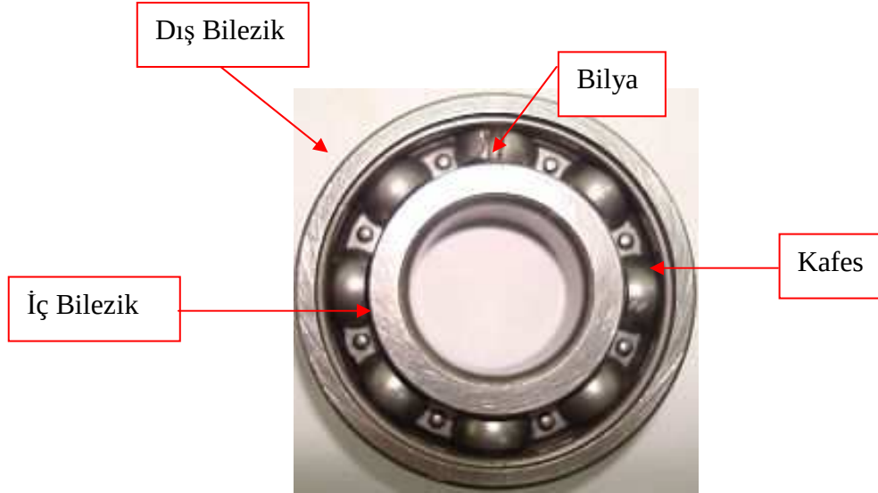
Şekil 1. 6. Döner tip rulman geometrisi
