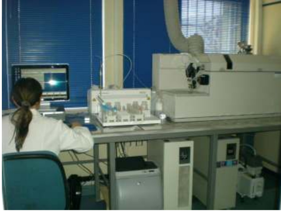
Şekil 3. AGILENT 7500A ICP/MS cihazı
