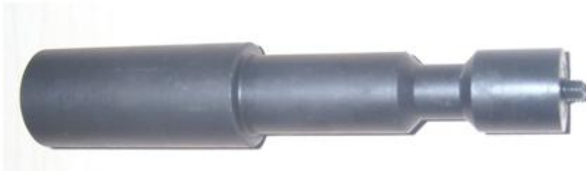
Şekil 6.2. SKK kullanılan karıştırıcı uç ve geometrisi
