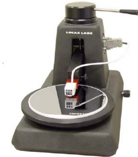
Resim 3.3. VO_x ince filmlerin elektriksel özelliklerinin belirlenmesinde kullanılan FPP sistemi.
