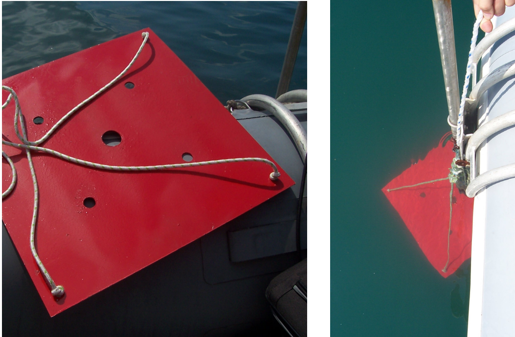
Şekil 5.17 Bar kontrolü levhası ve transdüserin altına doğru indirilmesi
