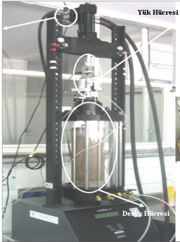
Resim 6.8. Esneklik modülü deney düzeneğı
