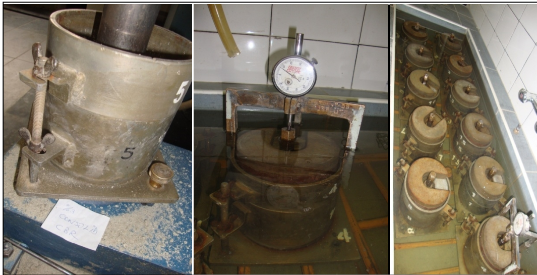
Resim 6.5. CBR şişme deneyi düzeneği
