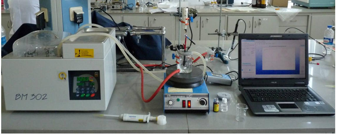
Şekil 3.2. Taze bakla dokusu biyosensörü ile yapılan ölçümlerde kullanılan düzenek
