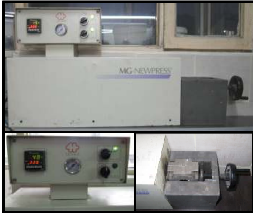
Resim 6: Asetal Rezine Enjeksiyon Makinesi.
