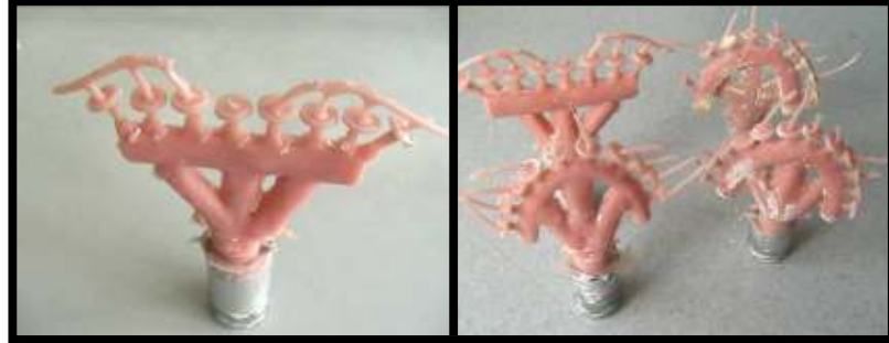
Resim 14: Asetal rezinin mufladan çıkmış hali.
