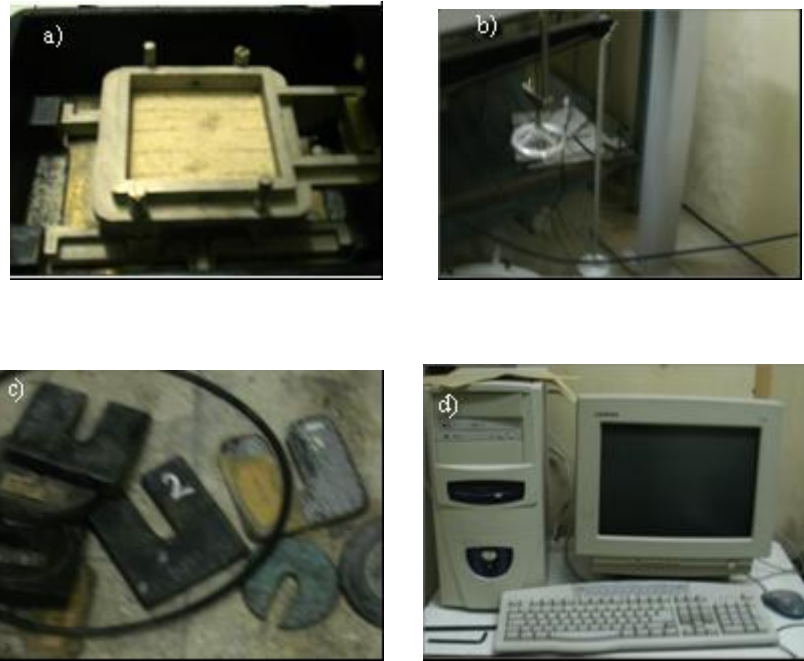
Şekil 3.5 Deney düzeneğine ait parçalardan kesme kutusu (a), konsolidasyonu sağlayan moment kolu (b) ve ağırlıklar (c) ile verilerin toplandığı bilgisayar sistemi (d)
