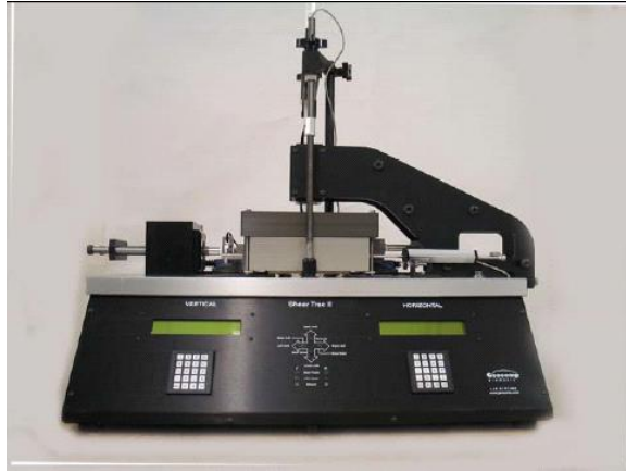
Şekil 3.6 Çevrimsel basit kesme deney aleti (Sheartrac-II-DSS)
