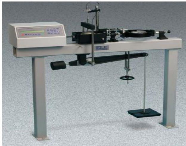
Şekil 3.4 Direkt kesme kutusu deney aleti ( ELE 26-2114)
