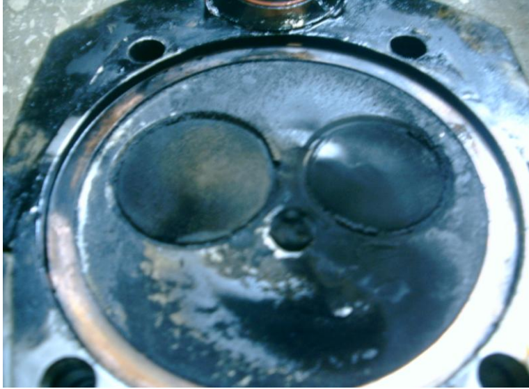
Şekil 3.55. Dizel yakıtıyla 100 saatlik çalışma sonunda silindir kapağı ve supapların görünümü
