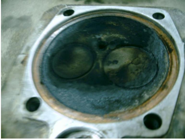
Şekil 3.56. Dizel yakıtıyla 100 saatlik çalışma sonunda silindir kapağı ve supapların görünümü
