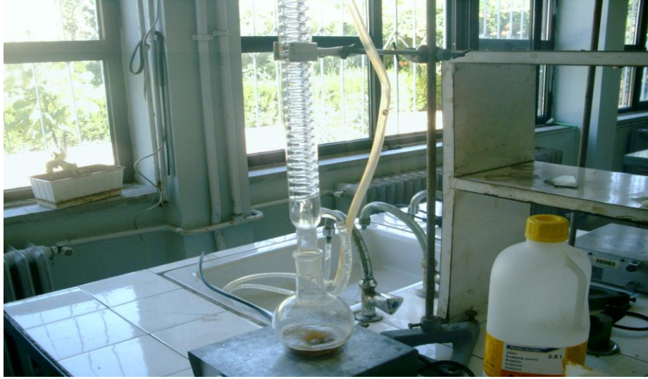
Şekil 2.17. Organometal bileşik sentezinde kullanılan reaktör.
